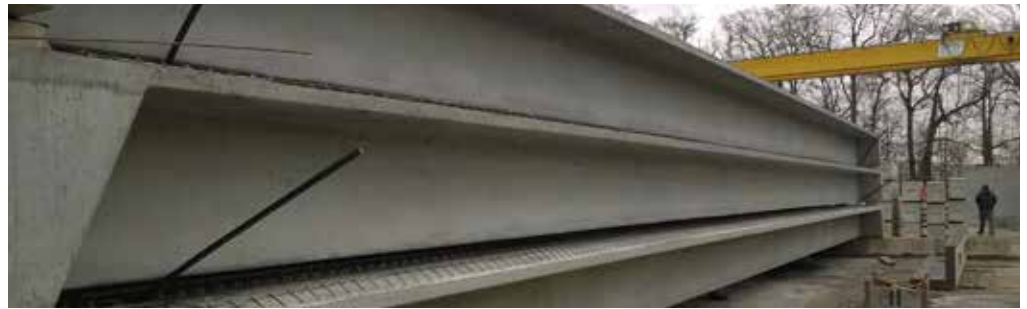
4 Probekörper nach Brandprüfung
