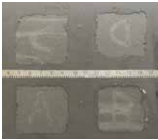
4 Probekörper nach Brandprüfung
